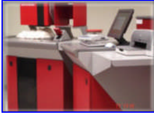
Resim 4.4: HVI 900 cihazı test ekipmanı
